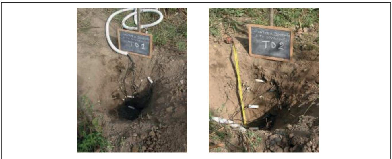
Figura 5. Profili di scavo e posizionamento dei sensori.
