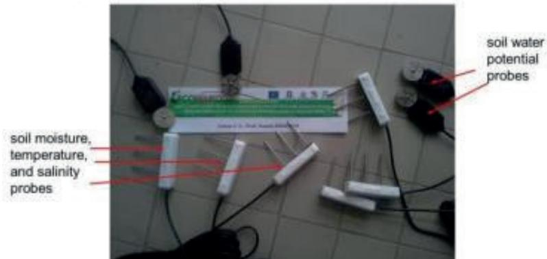
Figura 2. Sensori impiegati per la calibrazione del modello Hydrus-1D.
