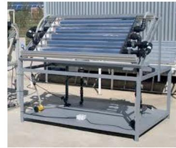
Figura 7. Fotoreattore tipo Compound Parabolic Reactor (CPC) (photo: P. Fernández Ibáñez, Plataforma Solar de Almería)
