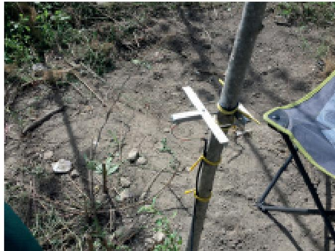
Figura 3. Dendrometro per la calibrazione dei flussi traspirativi della coltura di pioppo.
