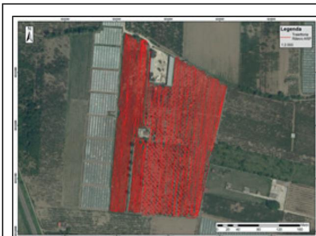
Figura 3. Schema delle scansioni effettuate con la tecnica ARP.
