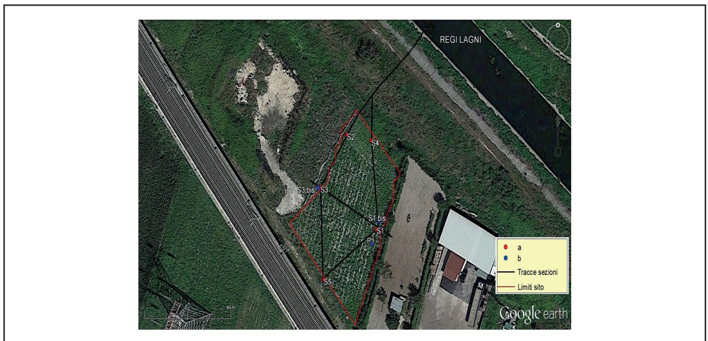
Fig. 5: Sito di Teverola, ubicazione delle perforazioni eseguite e tracce delle Sezioni idrogeologiche (Sez. A-A' = S5-S3-S2 Fig. 5); a) perforazioni a rotazione con carotaggio continuo; b) perforazioni a rotazione con distruzione di nucleo; P1: pozzo
